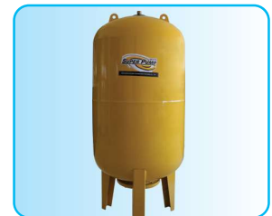
Pressure Tank - ถังแรงดันแบบไดอะแฟรม (200 ลิตร สำหรับรุ่น 2 แรงม้า และขนาด 100 ลิตร สำหรับรุ่น 1.5 แรงม้า) หน่วงเวลาหน่วงปั๊มสตาร์ทน้อย ประหยัดค่าไฟ ไม่มีเสียงดังราคาถูก - สามารถเปลี่ยนยาง Diaphragm ได้บำรุงรักษาง่าย
